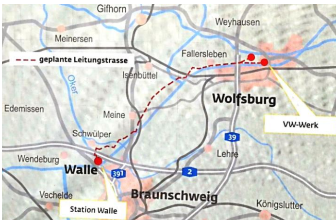
Verlauf der Gasleitung, Foto: Gerd Knoke
